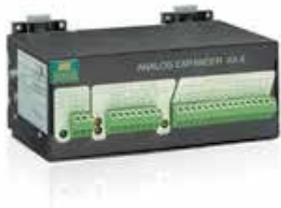
AX-8 模拟扩展器为电能表和需要使用模拟信号的其他设备提供接口。AX-8 可连接至任何配备有 RS-422 通信端口和具有模拟扩展器选项的电能表。提供 8 个通道以实现高分辨率模拟量输出。可以串联两个装置, 因此使用一个电能表即可提供多达 16 路的模拟量输出。提供一系列的选项, 包括电流输出或电压输出。尺寸: 3×7.3×5.1" / 76×186×130mm (高×宽×厚), 重量: 0.7kg/1.54lbs。
