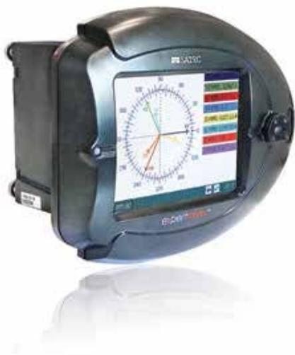
高级电能质量分析仪是配备高级电能质量分析功能的紧凑型多功能电力参数测量仪和计费表(0.2s级)。
